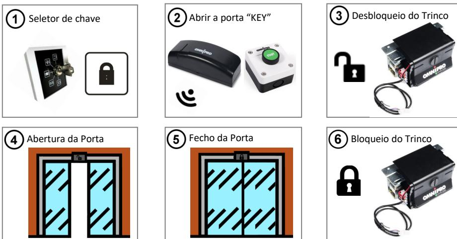
Esquema de conexões para funcionalidade do Trinco Elétrico em Modo Bloqueio
